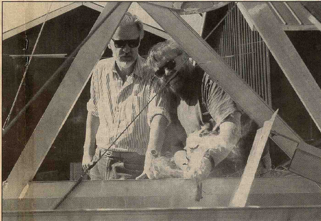
Långt innan solstrålningen koncentrerats till en brännpunkt uppstår så kraftig värme att en trägren inom någon sekund fattar eld. Själva brännpunkten ger en temperatur på omkring 3 000 grader, berättar Ambjörn Naeve och Tomas Elofsson som på bilden demonstrerar sin solkoncentrator.
